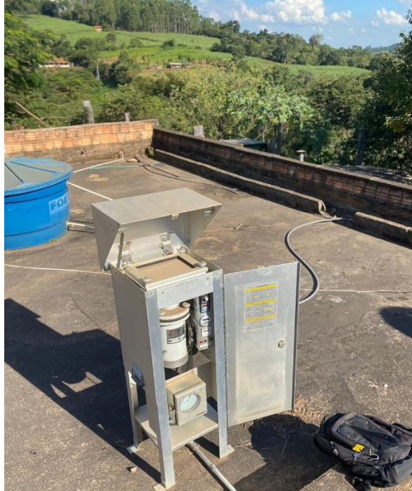
Figura 2 – Amostrador de Grandes Volumes – AGVPTS na Comunidade Minas Brasil/Germinal
