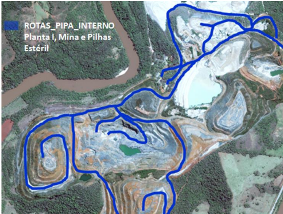
Figura 9. Rota dos caminhões pipa nos acessos internos (Planta I, Mina e Pilhas de Estéril)
